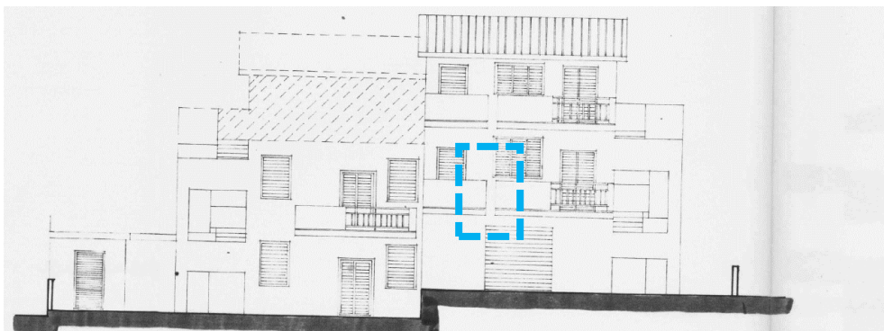
Prospetto principale – pratica di condono – balconi separati
